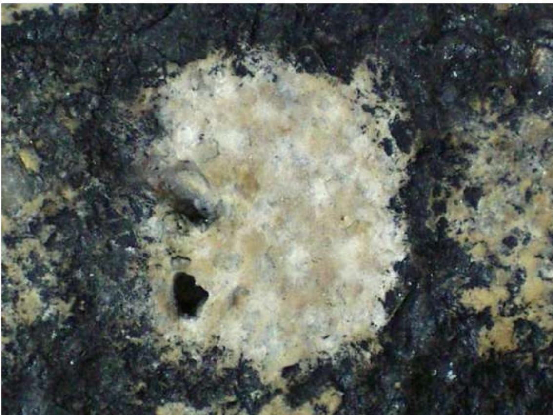
**FIGURA 11.** Resultado de la limpieza realizada mediante microabrasión sobre soporte pétreo abujardado
