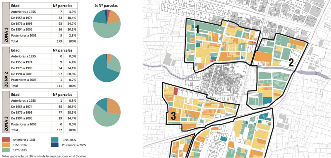
Fig. 2. Edad de la edificación (Fuente: (Cano Hurtado et al., 2018))
