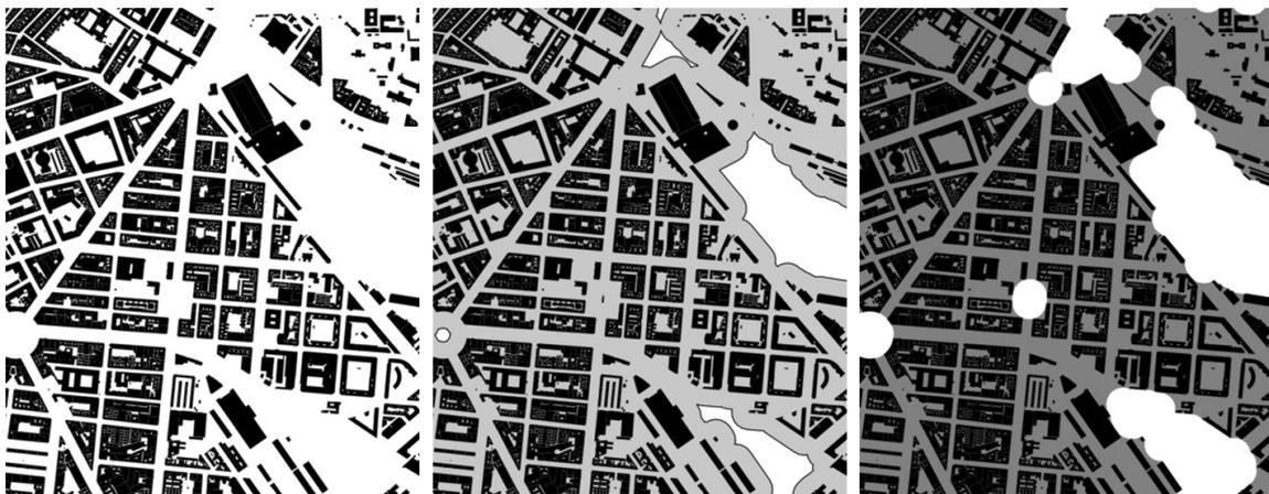
Fig. 1. Metodología de trazado de la huella de trabajo. De izquierda a derecha: ocupación en planta de los edificios según cartografía catastral, buffer de 50 m hacia el exterior, resultado final tras buffer de 50 m hacia el interior. Elaboración propia
