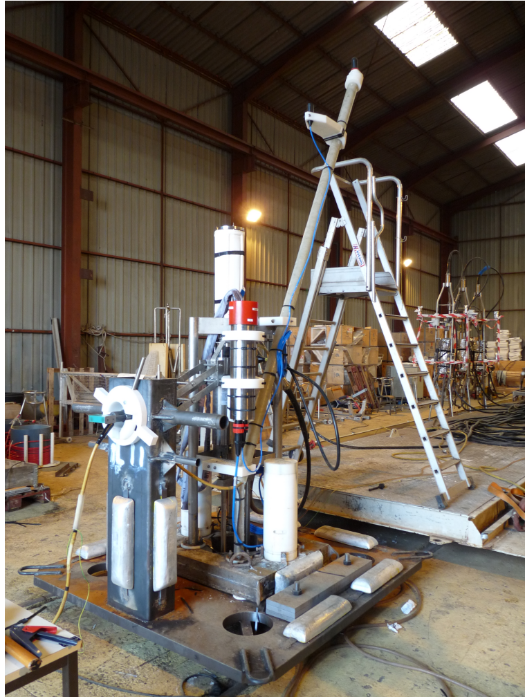
Figura 9.4: El recipiente del Laser del IFIC y el transductor FFR montados en el ancla de la IL011 de Antares.
