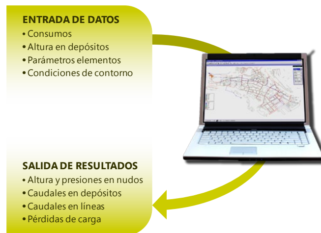
FIGURA C2-1. FLUJO DE DATOS EN LA SIMULACIÓN DEL MODELO MATEMÁTICO DE UNA RED
