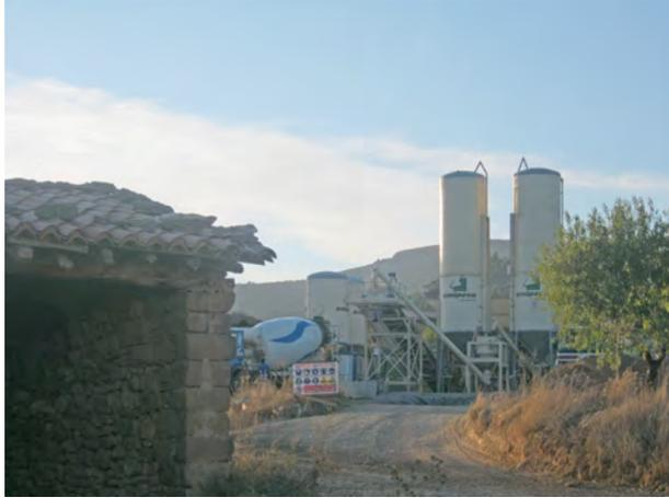
figura 4.- Central hormigonera, Alpuente. Fabricación hormigón para cimentación de molinos.
