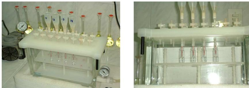
**Figura 9.** Colector múltiple de vacío ("Vacuum Manifold") y accesorios SPE
