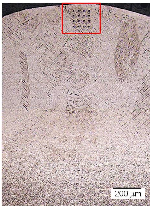
Figura 51. Microestructura del cordón y posición de la matriz de nanoindentación.
