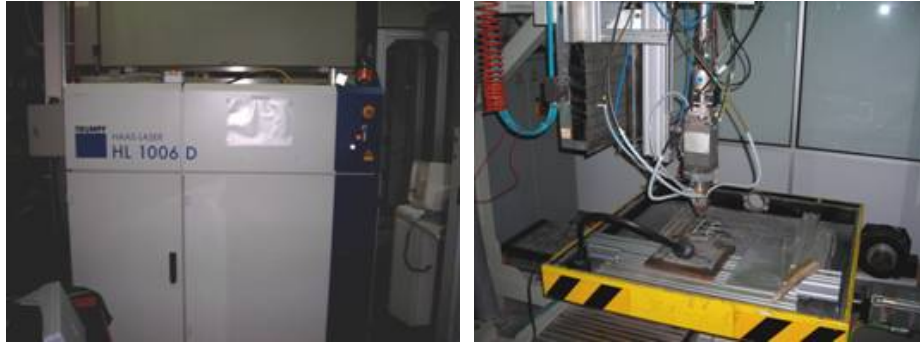
Figura 27. Equipo láser Nd:YAG Trumf 1kW CW (AIDO)
