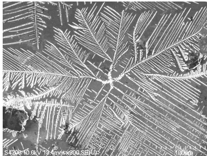
Figura 22. Ejemplo de imagen de una estructura de solidificación ultrafina en electrones secundarios del FESEM que se utilizará.
