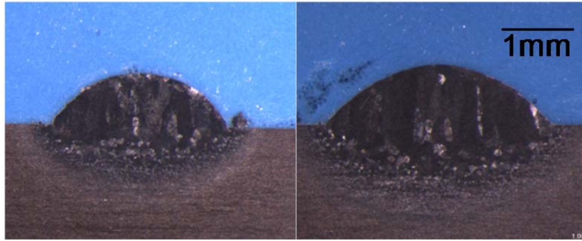
Figura 50. Corte transversal de las muestras M1 y M11 que se han seleccionado para el análisis de la oxidación.
