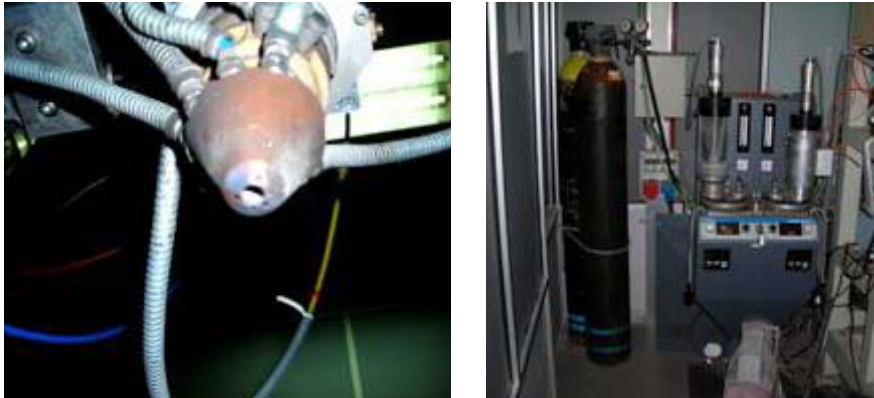
Figura 29. Boquilla coaxial y tolva para el polvo empleada en AIDO.
