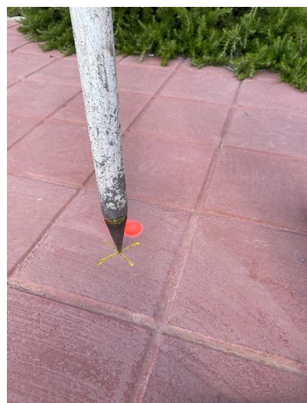
Figura 23. Foto jalón GPS sobre punto de control
