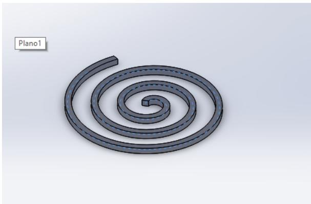
**Figura 3.6:** Geometría del electrodo de espiral de radio de 0.2 mm, 3 revoluciones y un paso de rosca de 0.8mm.
