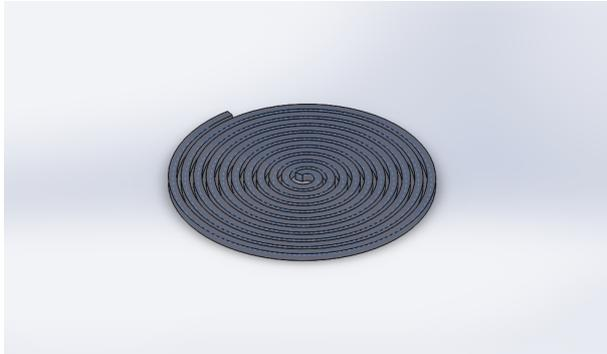
**Figura 3.4:** Geometría del electrodo de espiral de hilo de platino de radio de 0.2 mm, 10 revoluciones y un paso de rosca de 0.3mm.
