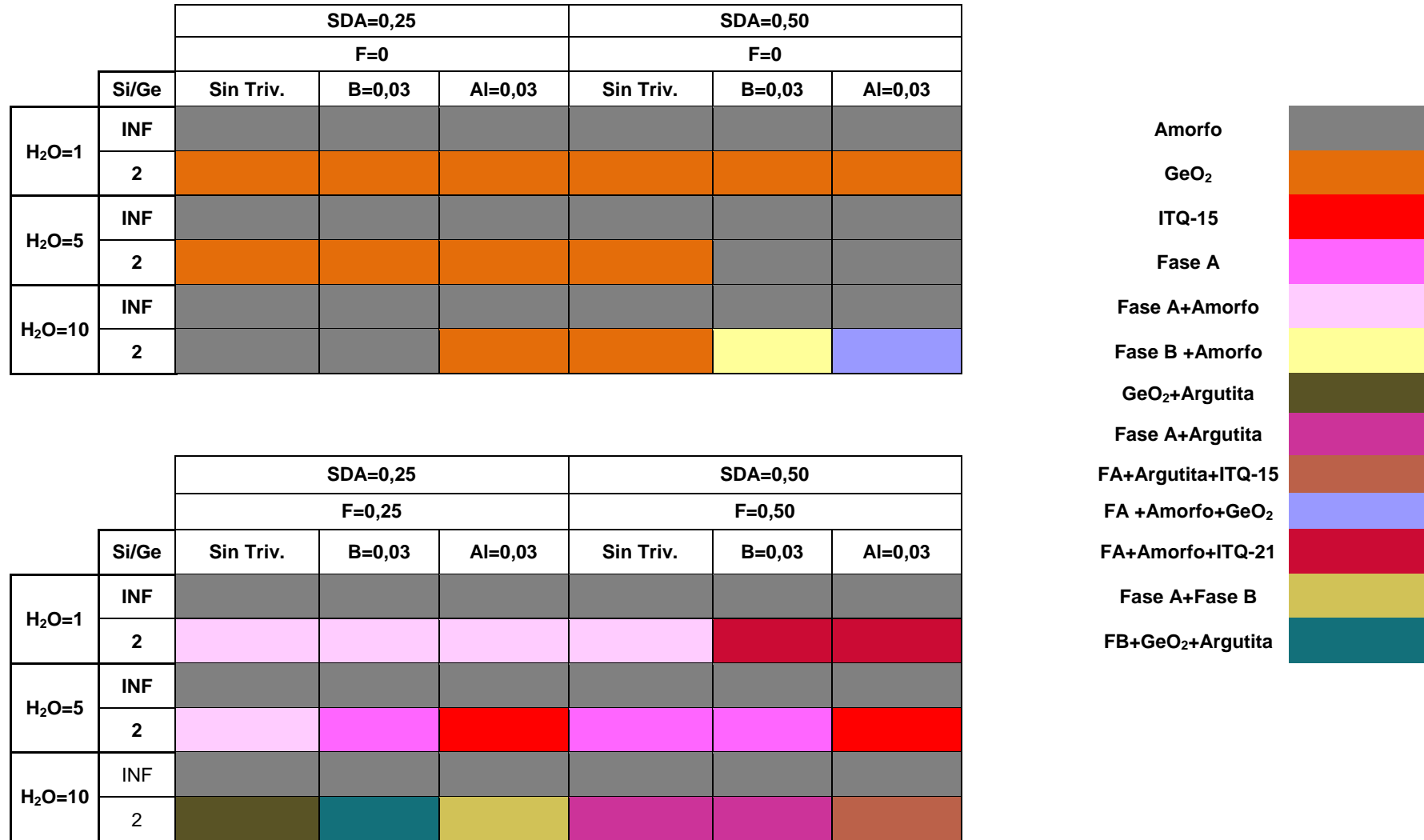
Figura 3.2. Diagramas de fases obtenidos con el primer barrido de condiciones empleando NELO-I como ADE.
