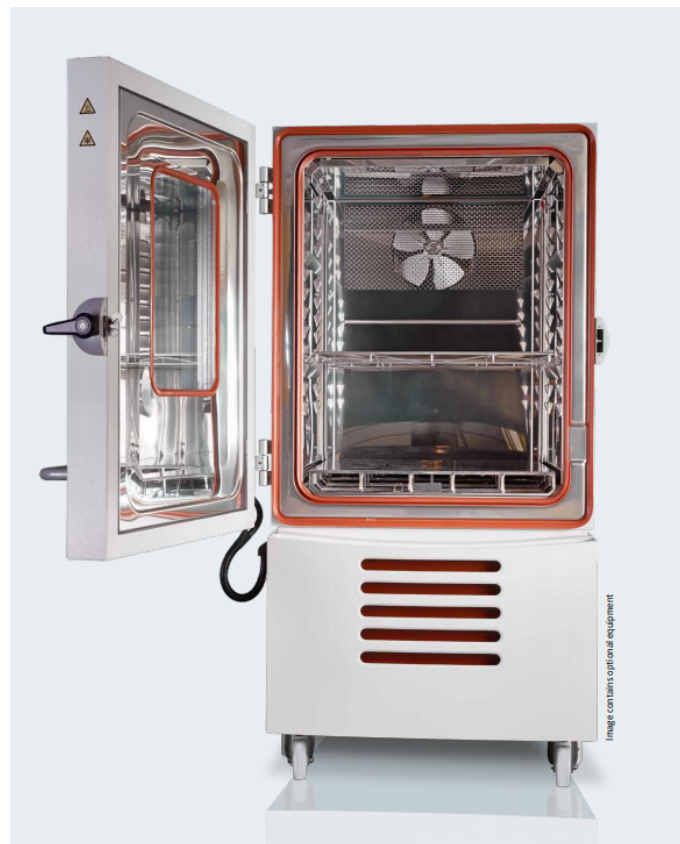
Figura 5.27: Imagen de la cámara de temperatura utilizada en las pruebas de temperatura a presión atmosférica.
