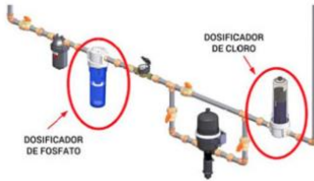
Imagen 28: dosificadores de Cl y fosfatos. Fuente: Selecciones avícolas.com
