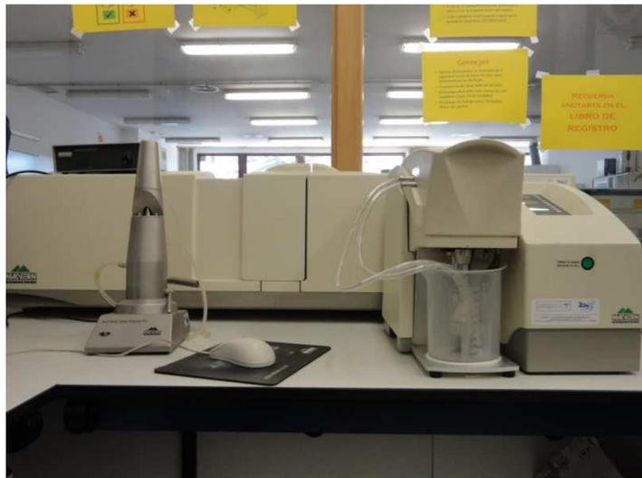
Figura II.6. Equipo de Granulometría por difracción láser
