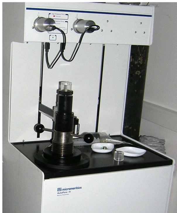
*Figura II.11 Equipo de Porosimetría por intrusión de mercurio*
