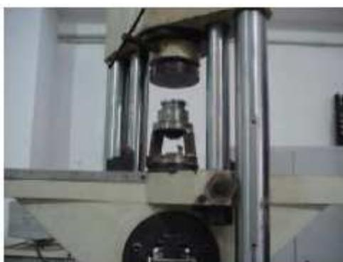
Figura II.10. Equipo de rotura a compresión de morteros
