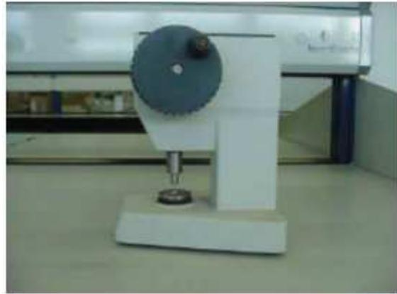
Figura II.8b. Máquina para sellar crisoles de aluminio
