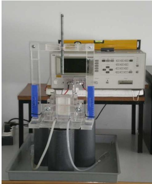
Figura II.7. Medidor de impedancias HP-4284 A.
