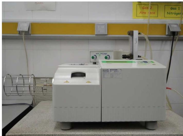
Figura II.8c. Equipo de termogravimetría
