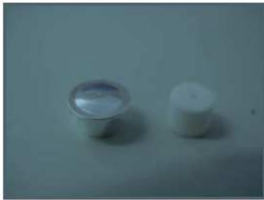
Figura II.8a. Crisoles de aluminio y alúmina
