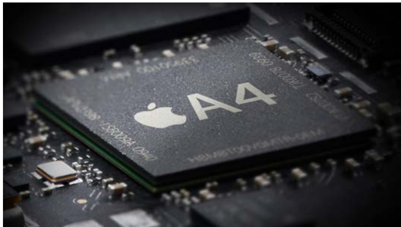
Imatge 16: Processador A4 de Apple utilitzat per iPhone e iPads.
