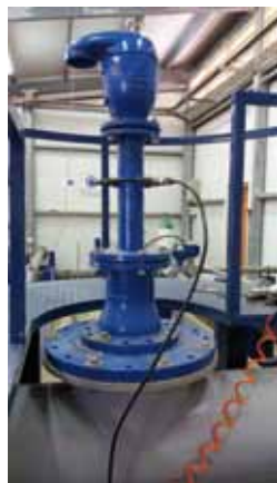
FIGURA 1. Imágenes de los bancos de pruebas en los que se llevaron a cabo los ensayos de ventosas.
