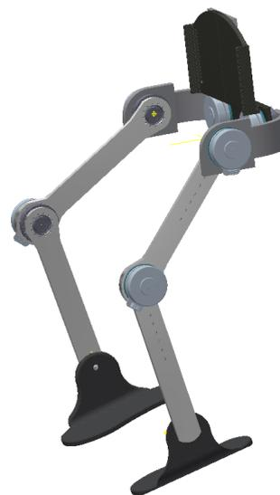
Figura 1: Exoesqueleto robótico de rehabilitación, ALICE
