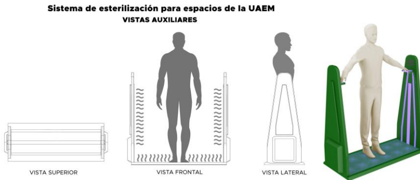
Fig. 2 Simulación 2D y 3D de la desinsectación por medio del sistema con luces UV-C. Fuente: Propia
