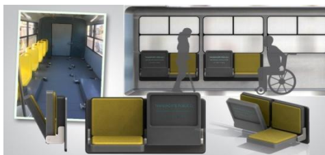
Fig. 7. Sillas plegables para aumento de capacidad
