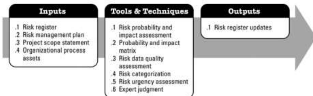
Ilustración 8 Entradas, herramientas, técnicas, y salidas en el analisis cualitativo de riesgos Fuente PMBOK edición 2008.
