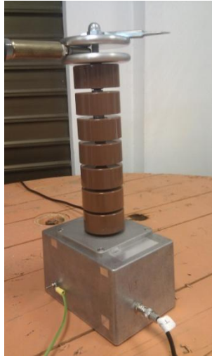
Figura 179. Elemento afilado en platos del sensor capacitivo para producir descargas parciales corona, [ep].
