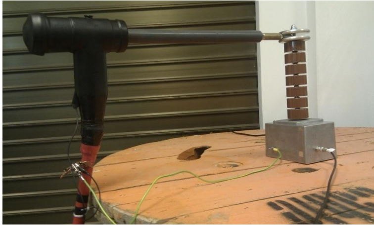
Figura 174. Detalle de conexión del cable con el sensor capacitivo de gran ancho de banda, [ep].
