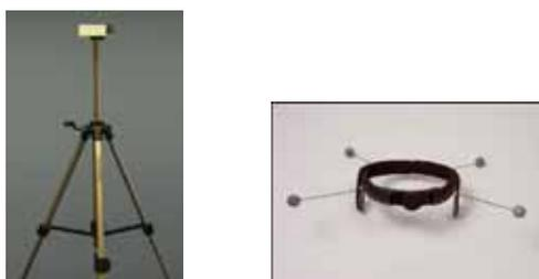
Figura 37. Espejo de referencia y casco de marcadores para la prueba de valoración funcional cervical
