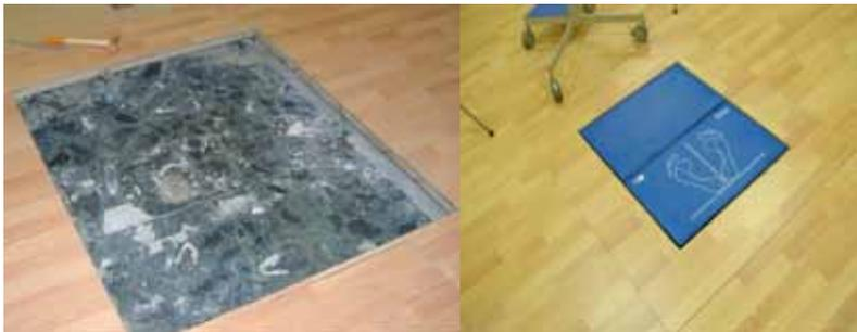
Figura 82. Detalle de colocación de la plataforma dinamométrica en tarima
