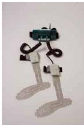
*Figura 18. Sistema Biofoot/IBV de plantillas instrumentadas. (IBV)*
