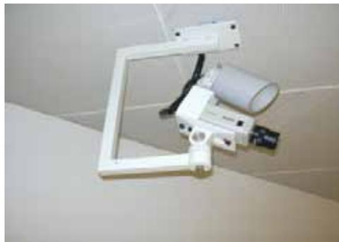
*Figura 87. Detalle de la instalación de las cámaras del sistema de análisis de movimientos*
