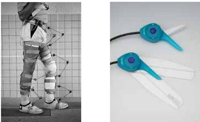
Figura 8. Ejemplos de electrogoniómetros. (IBV)
