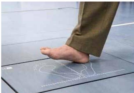
Figura 14. Plataforma dinamométrica. (IBV)
