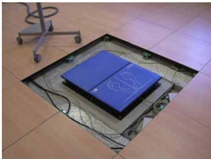
*Figura 80. Instalación de plataformas dinamométricas en suelo técnico*
