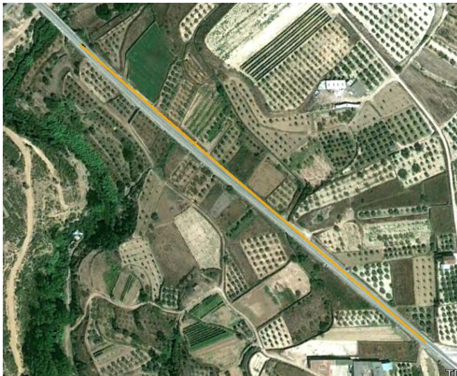
Figura 7.47 Detalle de la primera curva del tramo 1 no identificada por el ajuste de curvaturas con R_{máx} = 1000 m
