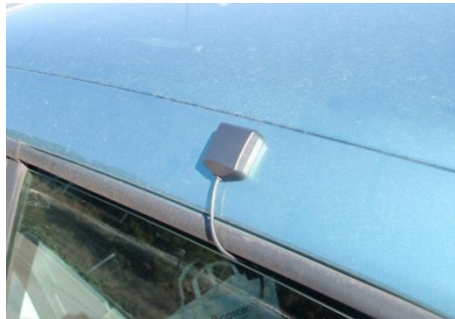
Figura 7.68 Antena del receptor GPS de 10 Hz
