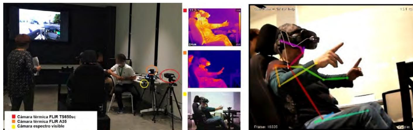
Figura 3. Ensayos y resultados con la empresa FAURECIA. Evaluación postural y térmica en simulador con realidad virtual. Confort postural y evolución térmica en extremidades y cara.
