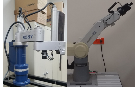
Figura 10: Izquierda: Mecanismo maestro, compuesto de los dos primeros eslabones del robot tipo SCARA. Derecha: Mecanismo esclavo, formado por los eslabones 2 y 3 del robot manipulador RV-M1.
