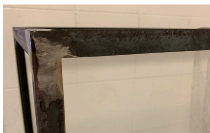
Fig. 24. Desarrollo de las piezas para Apreciamos el recuerdo cuando rozamos el peligro . Proceso de limado de las estructuras.
