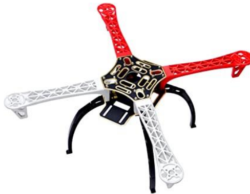
Figura 5: Foto de la estructura QWinOut F450 (Amazon, s. f.)
