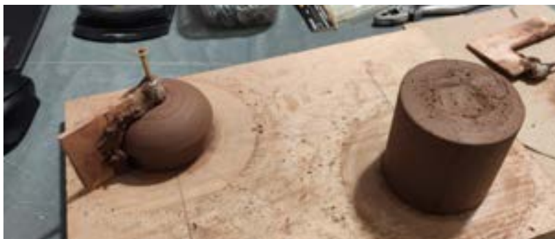
Fig. 34. Diego Vidal. Modelado de las dos piezas usando terrajas.
