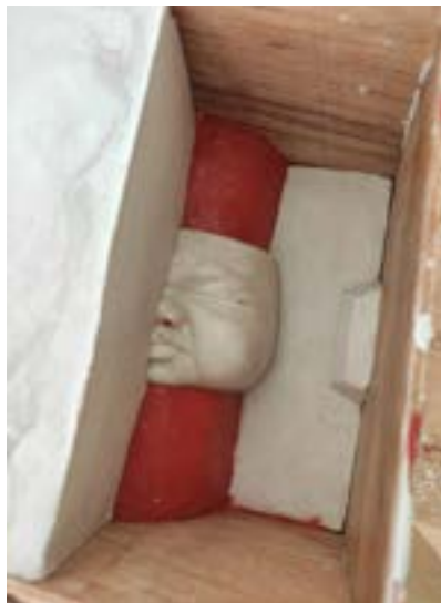
Fig. 47. Diego Vidal. Realización del molde de la tapa del salero.
