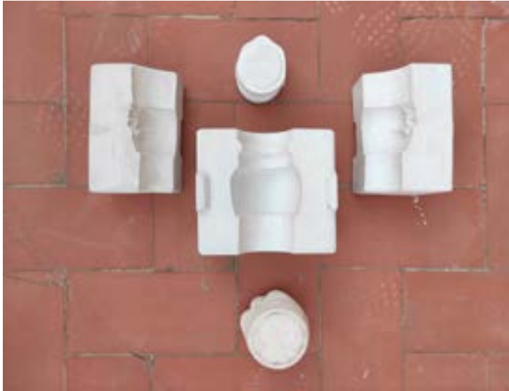
Fig. 49. Diego Vidal. Molde del salero terminado y abierto.
