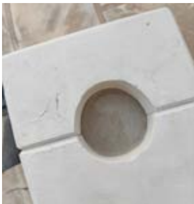
Fig. 51. Diego Vidal. Molde lleno de barbotina de porcelana.
