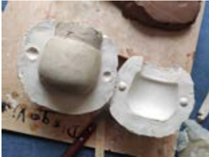
Fig. 44. Diego Vidal. Molde del azucarero comercial y copia en plastilina.
