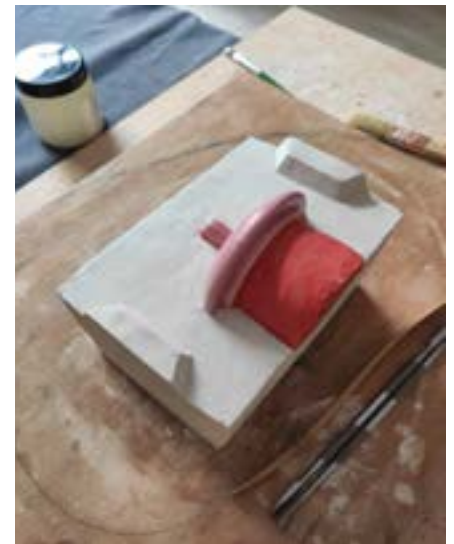
Fig. 48. Diego Vidal. Realización del molde de la tapa del salero.
