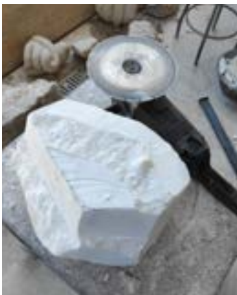
Fig. 25. Diego Vidal. Corte y dimensionado de la piedra con la ayuda de la radial.
