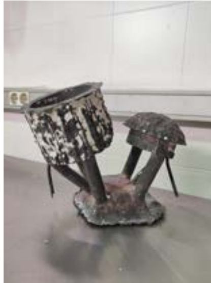
Fig. 39. Diego Vidal. Pieza de bronce salida del molde de cáscara cerámica.
