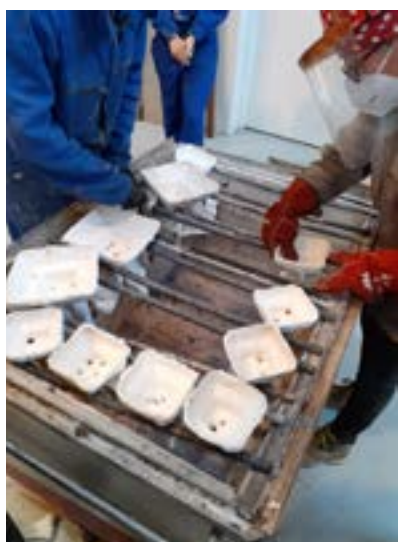
Fig. 37. Diego Vidal. Colocación del molde en el lecho de colada junto a Carmen Marcos.
