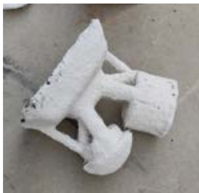
Fig. 36. Diego Vidal. Molde refractario terminado.
