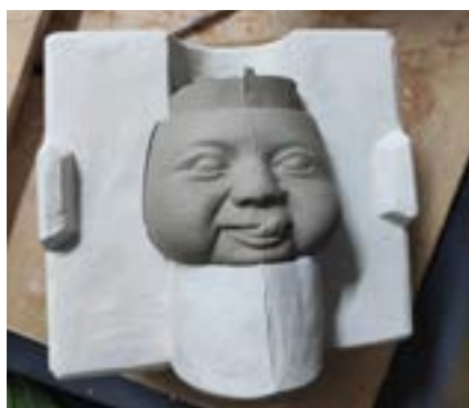
Fig. 59. Diego Vidal. Desmoldado de la copia de porcelana.
