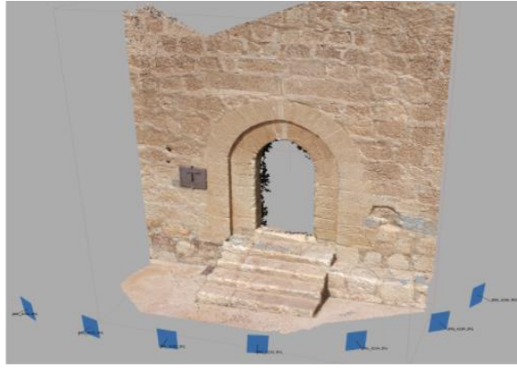
Figura 13: Levantamiento topográfico tridimensional empleando técnicas de fotomodelado. (Fuente: Colegio de Arquitectos de Murcia (12))
