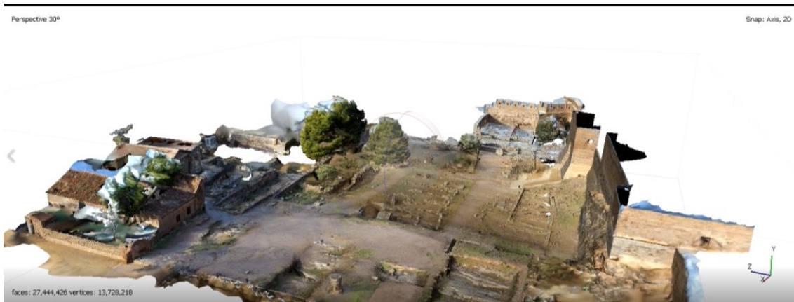
Figura 29: d) Modelo 3D del foro romano del castillo de Sagunto realizado con el software Agisoft Metashape Professional. (Elaboración Propia)
