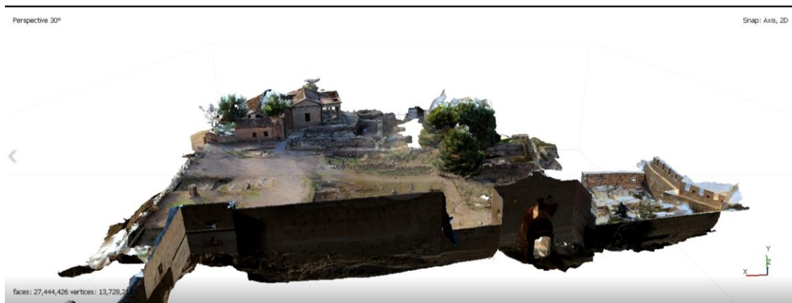
Figura 26: a) Modelo 3D del foro romano del castillo de Sagunto realizado con el software Agisoft Metashape Professional. (Elaboración Propia)
