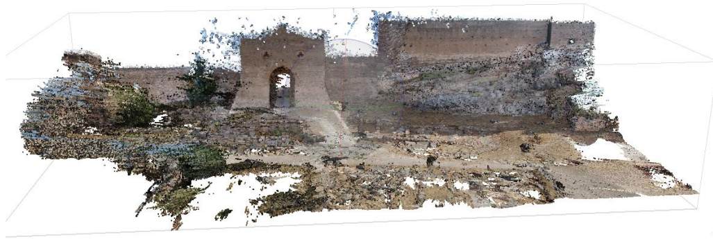
Figura 22: Modelo de nube de puntos densa junto con mapa de profundidad creada con Agisoft. (Elaboración Propia)
