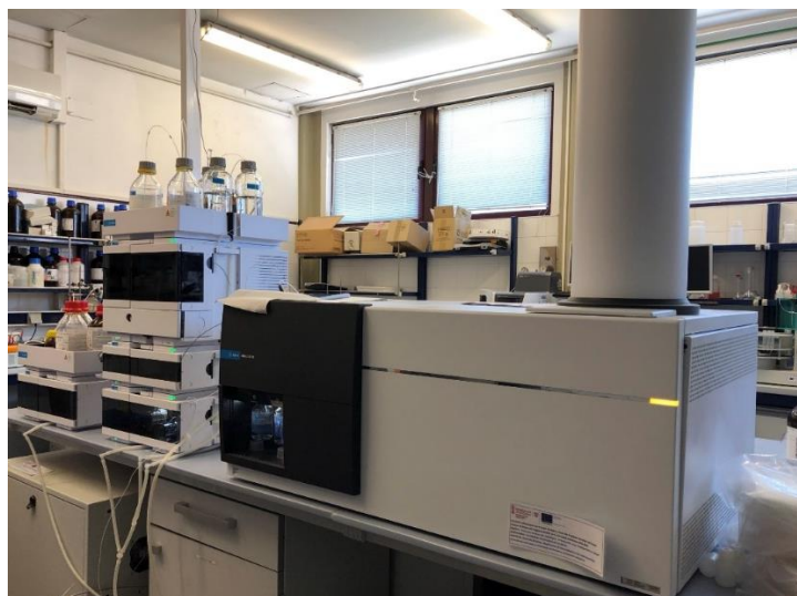
Figura 19. Equipo LC-ESI-qToF-MS utilizado para la caracterización del perfil fenólico.
