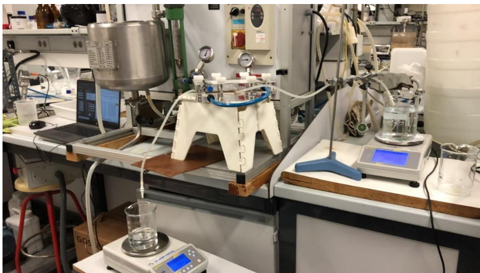
Figura 15. Imagen de la planta de ultrafiltración.
