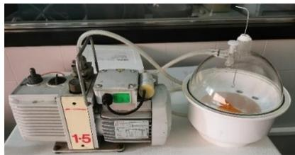
**2. IMAGEN 3.** Cámara-desechado con bomba de vacío
