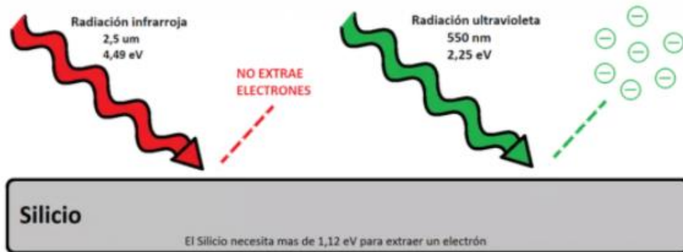
Ilustración 12. Representación de la incidencia de diferentes radiaciones en una placa de Silicio. (Fuente: helioesfera [9])
