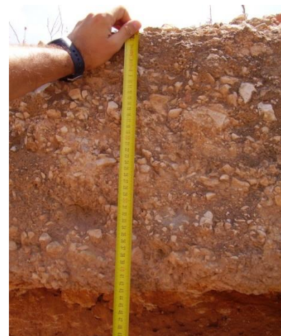
Figura 315. Costra te techo de 25 cm. en acceso. Cueva 03_04_94 de Hondón de las Nieves
