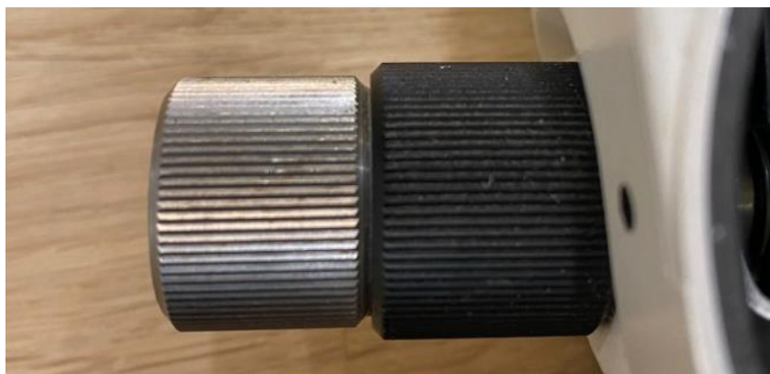
Ilustración 17. Ruedas de ajuste de los aumentos de la lente.
