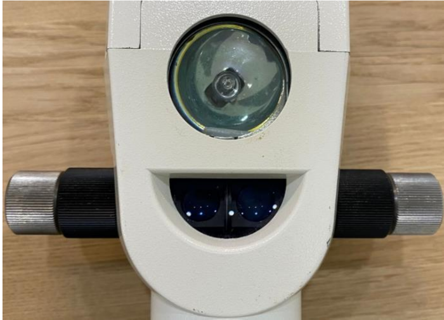
Ilustración 20. Vista trasera del colposcopio. Sistema de iluminación.
