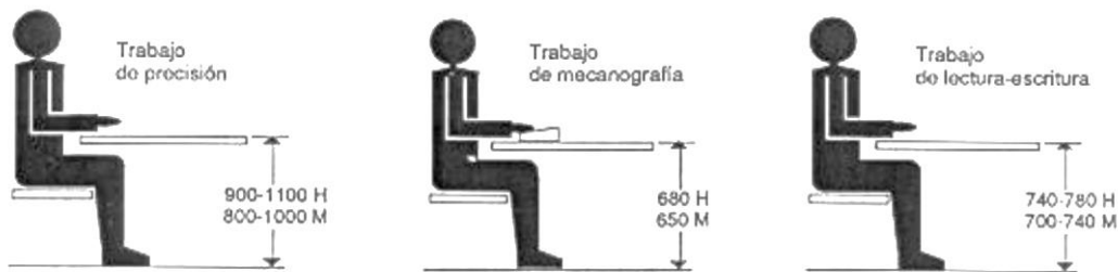
Ilustración 22. Altura del plano de trabajo para puestos de trabajo sentado (cotas en mm).
