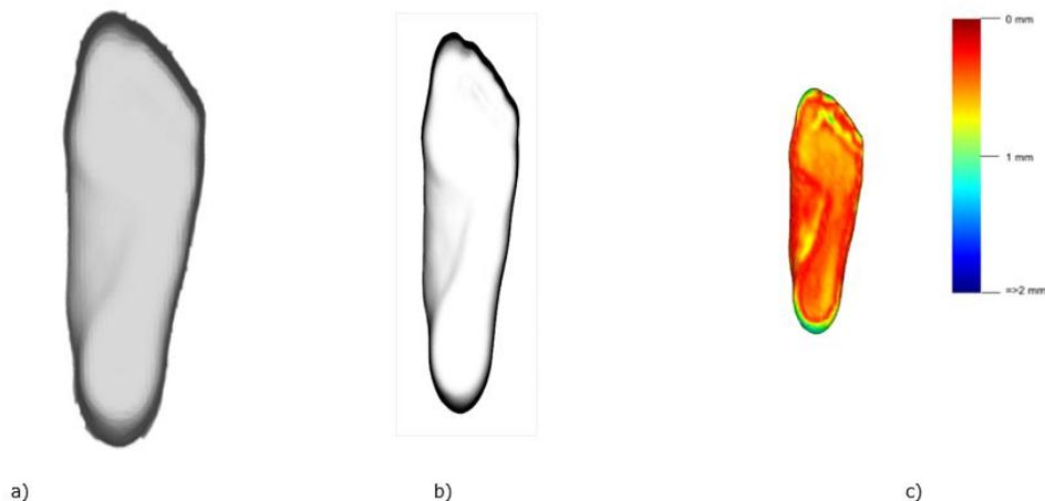
Figura 6. a) Modelo 3D obtenido con BOXIAL, b) modelo CAD de referencia, y c) mapa de distancias entre ambos modelos.
