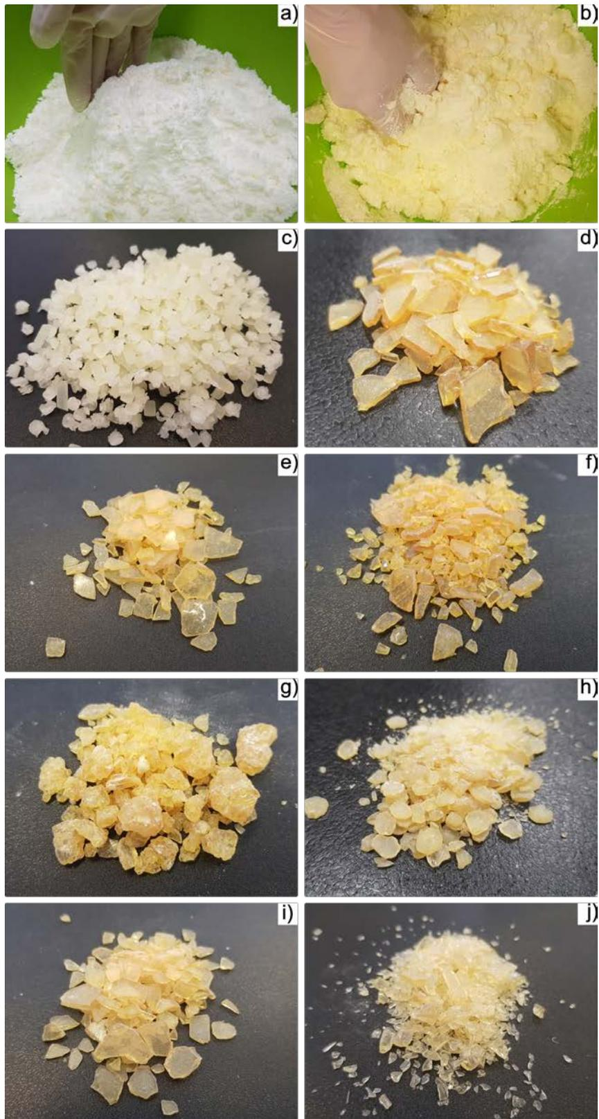
**Figura III.1.** Apariencia de los materiales utilizados: a) almidón nativo, b) TPS sin procesar, c) TPS procesado, d) TEGR, e) GR, f) CM, g) RD, h) UT, i) UG, j) LF
