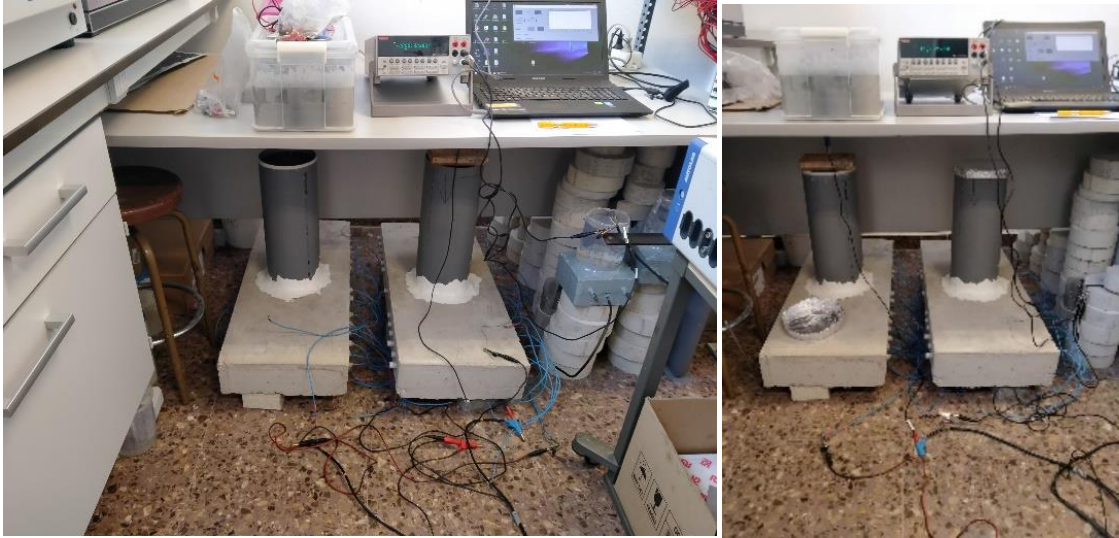
Imagen Nº 53. conexiones ensayo PSV medida de i_{local} etapa 2
