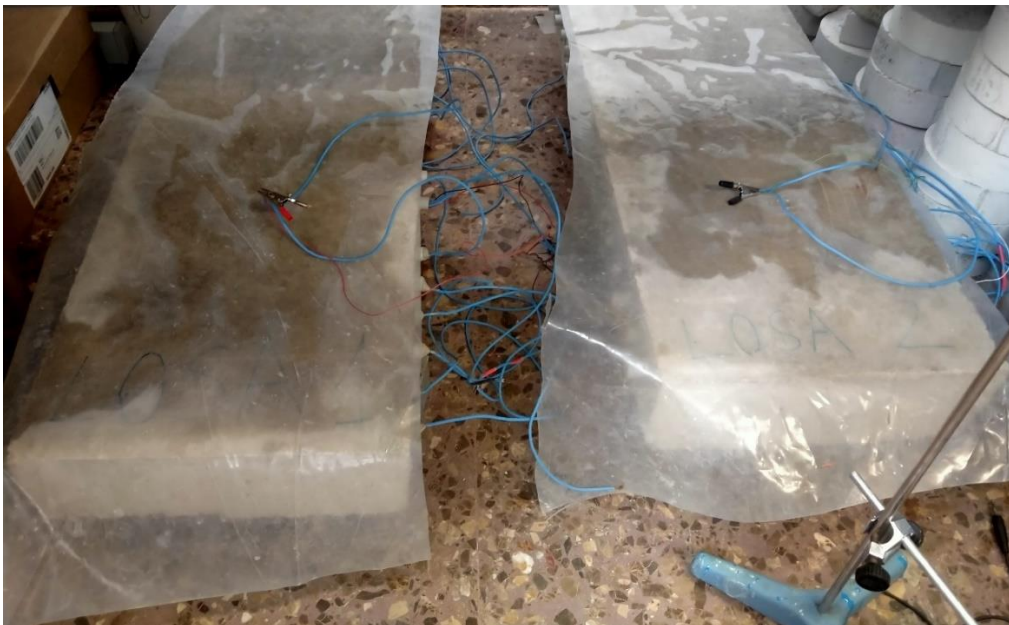
Imagen Nº 44. Fotografía losas de hormigón armado en laboratorio de electroquímica
