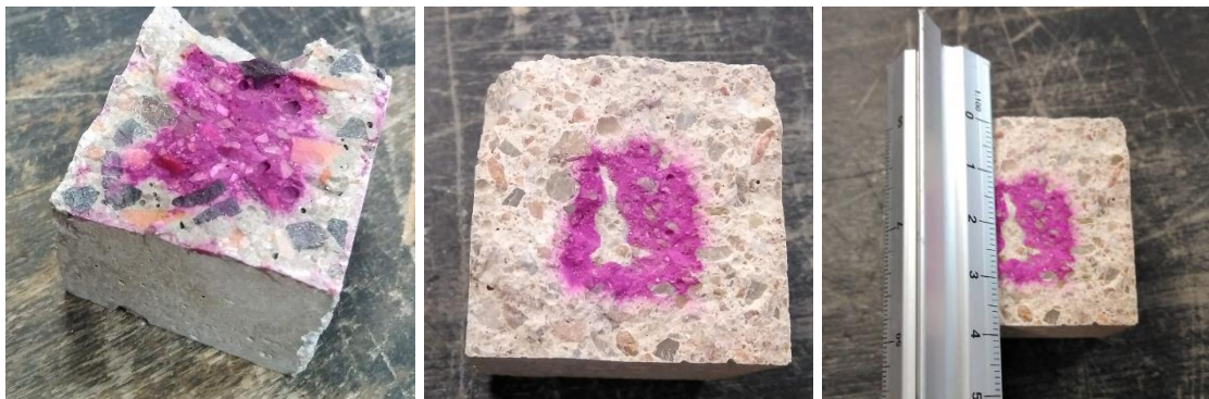
Imagen Nº 14. Revelado de carbonatación con fenolftaleína.
