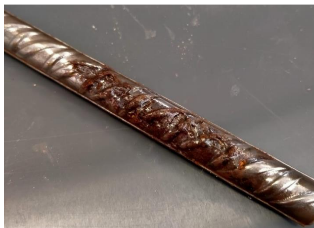
Imagen Nº 3: Corrosión por picadura.
