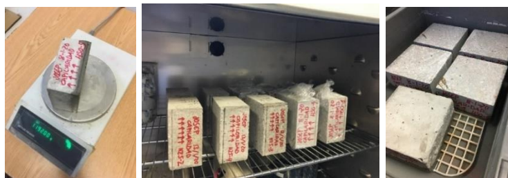
Imagen Nº 47. Ensayo de absorción de agua por capilaridad.
