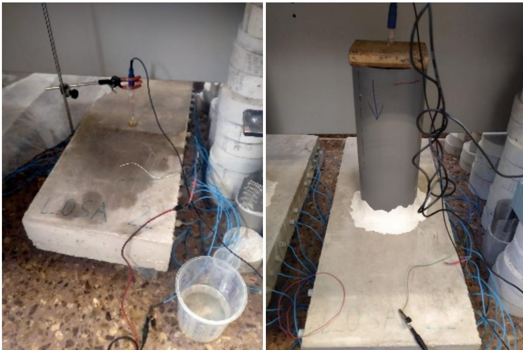
Imagen Nº 58. Electrodo de referencia, conexión a las losas etapa 1 y etapa 2
