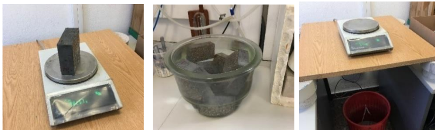
Imagen Nº 46. Ensayo de absorción de agua, densidad y porosidad.
