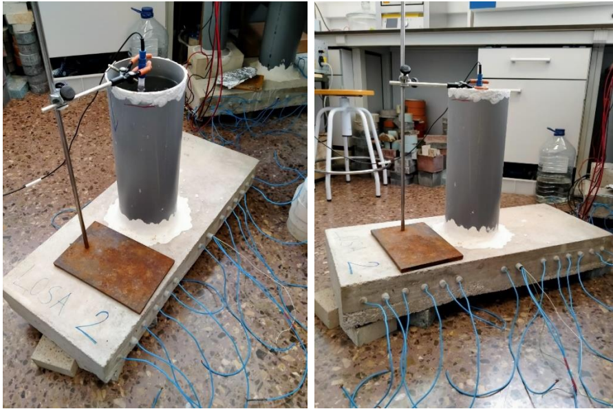
Imagen Nº 59. Electrodo de referencia, conexión a las losas
