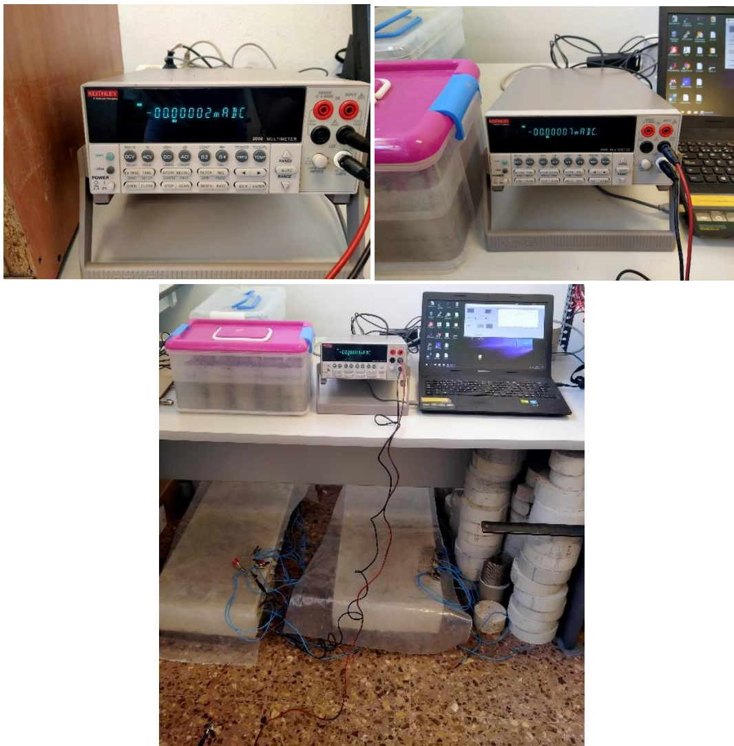
Imagen Nº 51. Medida de la intensidad de macrocelda con amperímetro de resistencia casi nula (ZRA)
