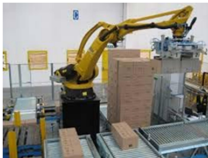
Figura 3.2. Ejemplo de aplicación pick & place. Paletización. (Valera Fernández, 2020b; diapositiva 17)
