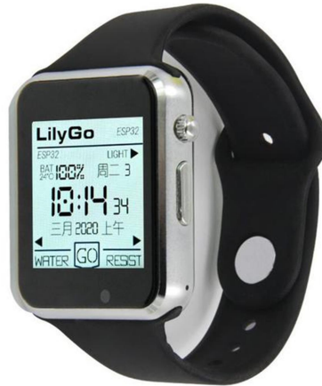
Figura 3.3. Dispositivo LilyGo con Acelerómetro triaxial BMA423, utilizado en el TFM.
