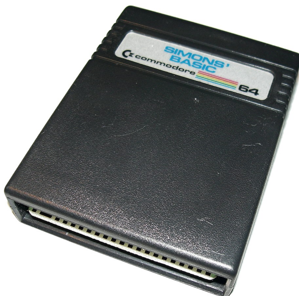
Figura 6.1: Cartucho de expansión Simon's Basic para la C64. Estos cartuchos de expansión permitían ampliar la cantidad de comandos BASIC que podían utilizarse en el ordenador.
