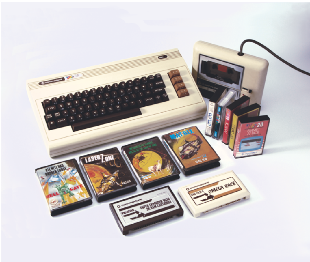
Figura 4.1: Microordenador VIC-20 con videojuegos en formato casete y cartucho. La distribución de los videojuegos se realizaba mediante formatos externos como disquetes, casetes o cartuchos.
