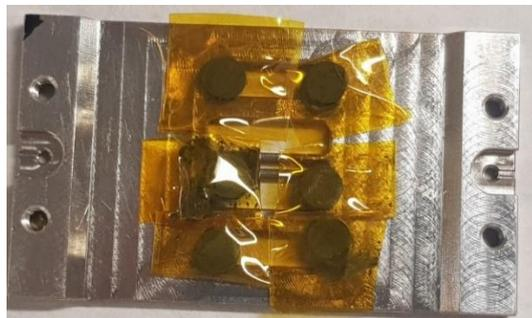
**Figura 6.5.** Portamuestras empleado para la adquisición de los espectros de absorción de rayos-X de muestras sólidas donde se aprecia la preparación y disposición de las muestras con recubrimiento de cinta de Kapton (naranja)
