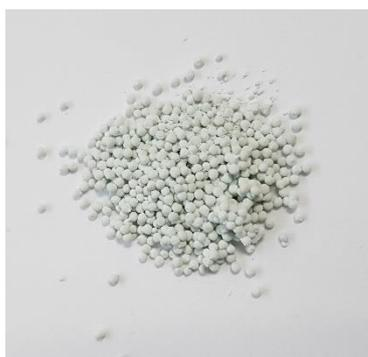
**Figura 5.9.** Esferas de CaA/ $\text{SiO}_2$ .
