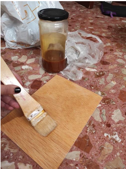
Fig 28. Imagen del proceso de barnizado con goma laca.
