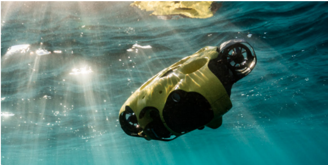
Figura 1.2: Drone submarino autónomo, creado por la empresa Notilo Plus, que integra una placa NVIDIA Jetson TX2, con un procesador de arquitectura ARM.
