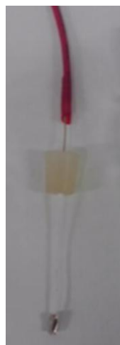
Figura 3. 4. Electrodo de trabajo, Pinza de oro en donde se coloca el sustrato de vidrio conductor
