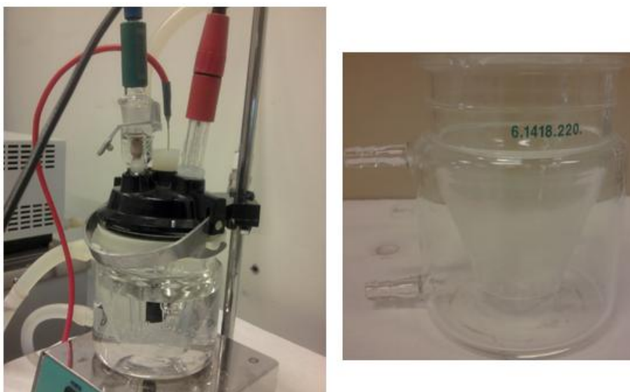
Figura 3. 5. Celda electroquímica y montaje experimental de la celda con los electrodos
