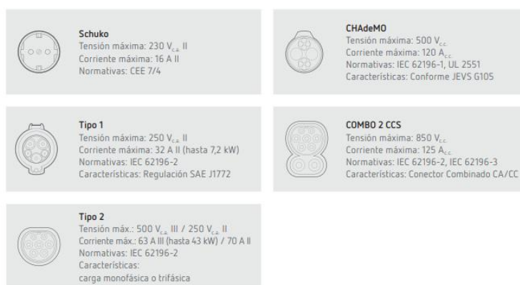
Figura 18. Tipo de conectores para los modos de recarga. Fuente: Circutor.
