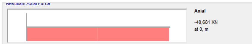
Figura 28. Resultados de esfuerzos axiales generados en las barras. Fuente: SAP2000.
