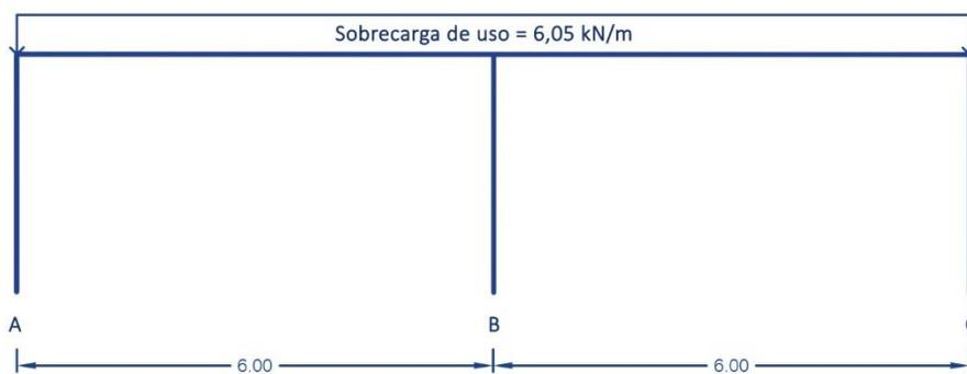
Ilustración 8. Sobrecarga de uso en la cubierta del pórtico interior
