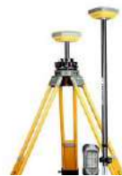
GNSS Geodésico (Fase)
