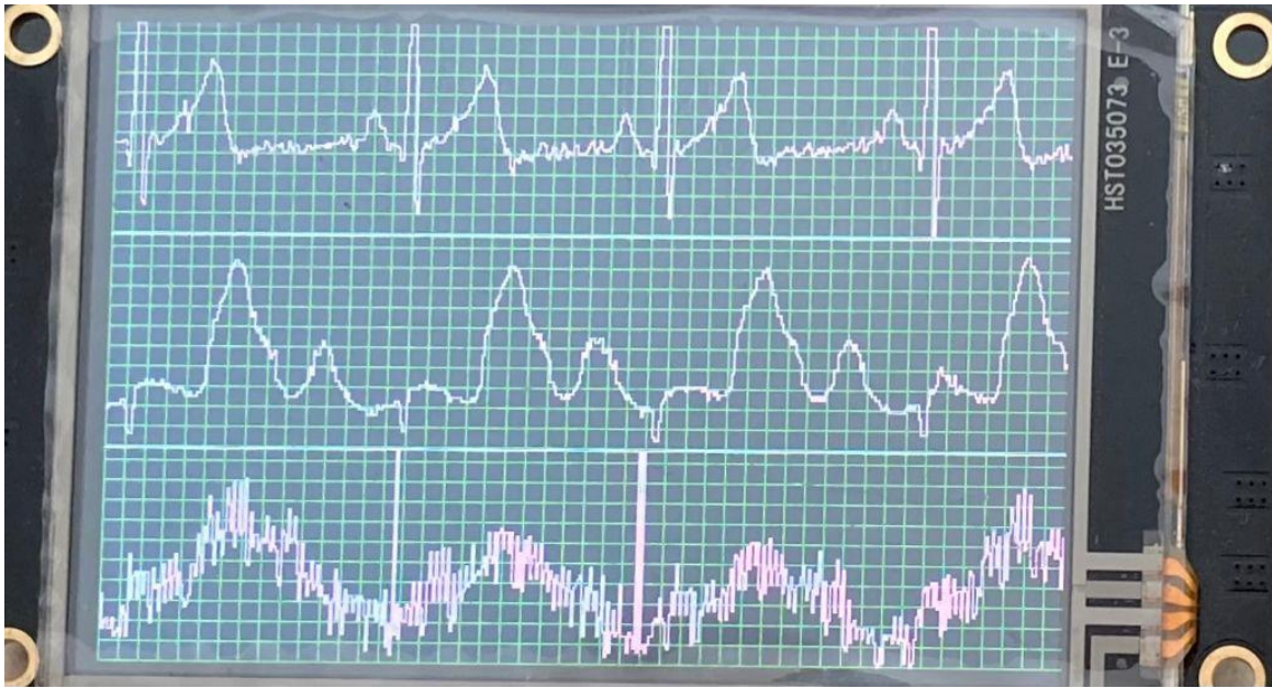
Figura 11. Señal ECG, PPG y respiración en la pantalla LCD Nextion.
