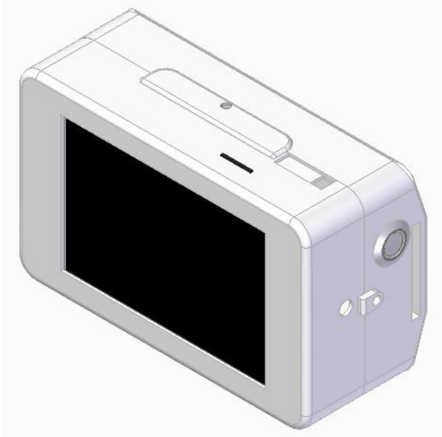
Figura 19. Carcasa fabricada con impresión 3D, en ABS.
