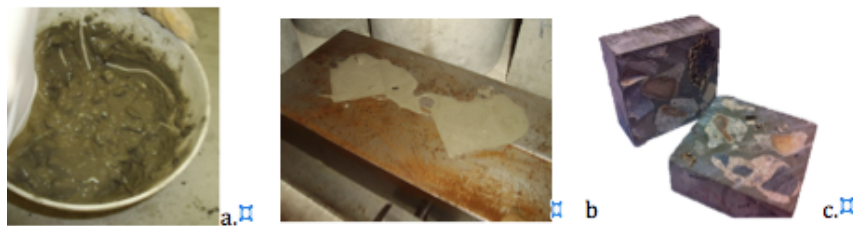
Figura 7.14 Procedimiento para la preparación de las muestras para evaluar la zona de transición árido/pasta. A. Mezcla de la pasta y los áridos. B. Moldeo de la pasta en estado fresco para obtener especímenes cúbicos de 40 mm. C. Especímenes extraídos de las muestras cubicas y posteriormente pulidos para su observación en microscopía electrónica de barrido.
