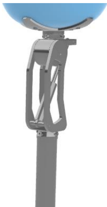
Imagen 66. Detalle del mecanismo de la rodilla.
