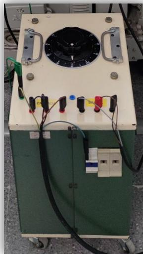
Fig. 77: Autotransformador. Fuente: Alejandro RA.
