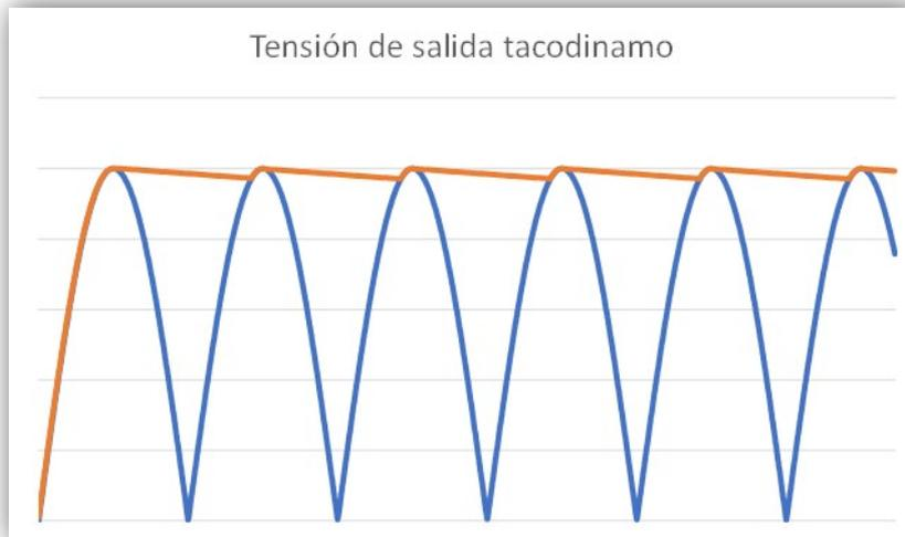
Fig. 17: Tensión de salida de una tacodinamo con rectificación y sin. Fuente: Alejandro RA
