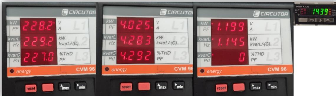
Fig. 81: Mediciones del analizador de redes a 1440rpm. Fuente: Alejandro RA.
