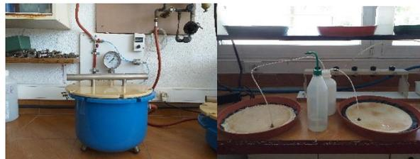
Figura 6a) Figura de la olla de baja presión utilizada para extraer el agua sobrante que el suelo es capaz de almacenar a -0.333 atm. 4b) Imagen de las bandejas sobre las que se colocan el suelo y que son capaces de extraer el agua que sobra de los cilindros de suelo
