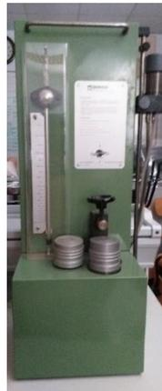
Figura 7: Porómetro de mercurio utilizado para la medición de la porosidad
