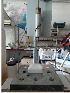
Figura 5: Imagen del instrumento utilizado para tamizar en húmedo las muestras de suelo
