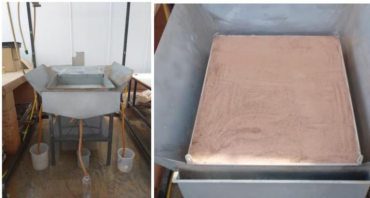
Figura 4a: Imagen del simulador de lluvia. 4b: imagen de una bandeja de suelo colocada en el simulador
